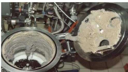
Ce petit réacteur a parfaitement fonctionné et son filtre de sortie d'air n'a pas été colmaté malgré le capteur de mousse totalement encrassé.
