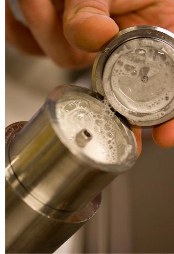
Vue de la nouvelle coupe anti-mousse avec le couvercle
